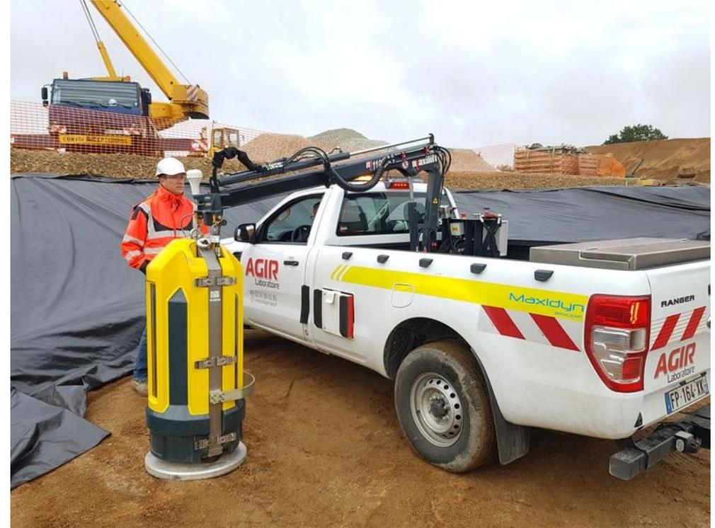
Essai de plaques (résistance du sol) pour l'éolienne N°1.
