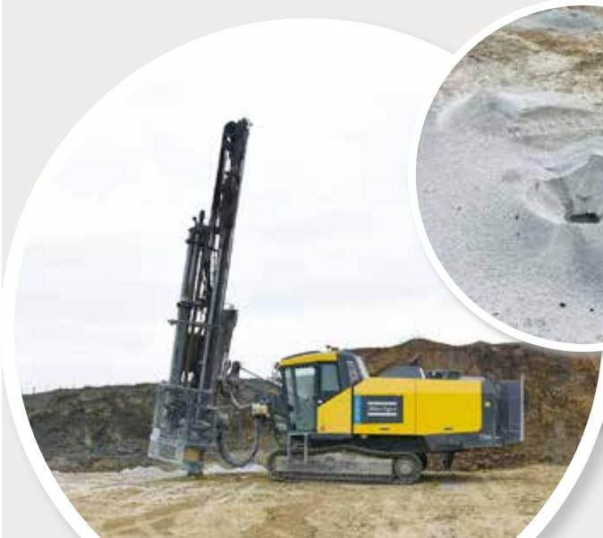
La foreuse creuse une multitude de puits (en détail) pas plus larges qu'une grande bouteille d'eau pour y déverser l'explosif.
