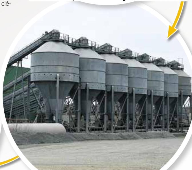
Ces sept silos contiennent du granulat de différentes catégories prêt à être distribué via le convoyeur situé en-dessous.
